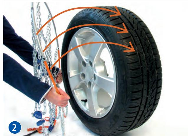
**DE** Die Kette an den **farbigen Bügelenden** erfassen. Das Kettennetz muss geordnet am **Bügel** hängen wie auf der Abbildung. Gegebenenfalls verschlungene Kettenstücke über den **Bügel** zurückdrehen.
