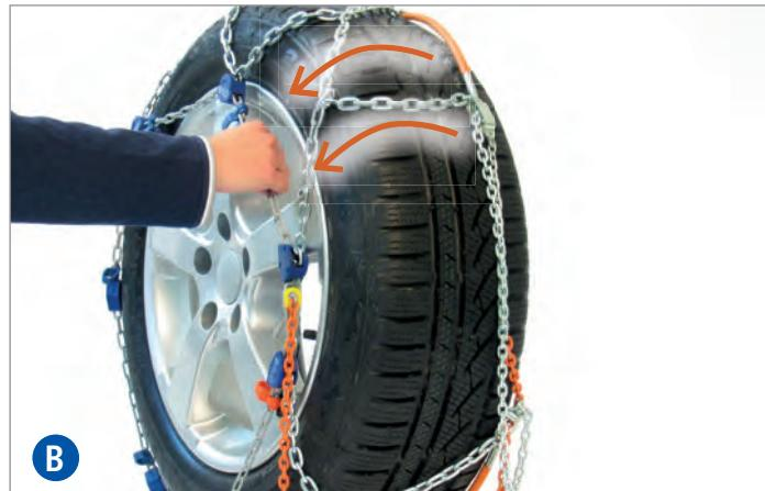
**DE** Radstellung so, dass die **farbige Lochplatte** etwa in Achshöhe liegt. **Verwahrhaken aus Außenkette** aus-hängen. **Spannkette aus Lochplatte** ausrasten, bis zum Anschlag zurückziehen und wieder einrasten.
