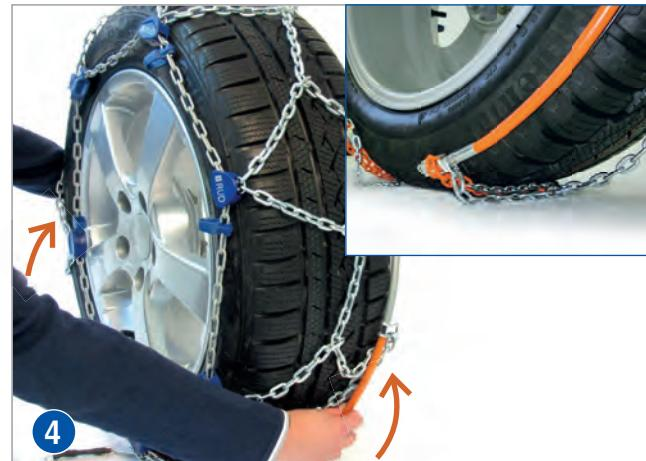
...von oben über den Reifen schieben, bis die **Außenkette** in der Mitte der äußeren Reifenflanke liegt.
