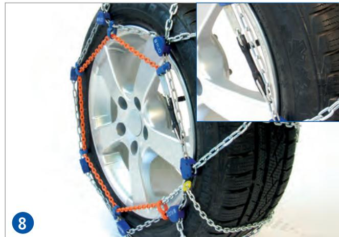
Vollständig nach außen gezogene **Spannkette** durch die **farbige Lochplatte** ziehen (Lochplatte mit einer Hand unterstützen und in Richtung **Reifenlauffläche** drücken) und unter Spannung in der Lochplatte einrasten. Kontrolle für korrekte Montage: Der farbige Teil der **Spannkette** muss vollständig durch die **Lochplatte** gezogen sein, je nach Größe des Reifens auch mit mehreren Gliedern Abstand.
