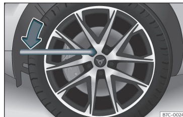
Afb. 32 Wiel verwisselen: wielbouten losdraaien.
