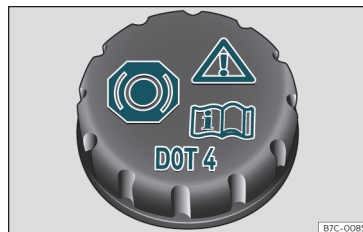
A fb. 261 Motorruimte: dop van het remvloeistofreservoir.
